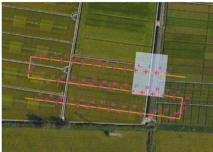
Fig. 3 - Piano di volo che ha seguito il drone durante il rilievo sul campo sperimentale. La linea arancione rappresenta la traiettoria del volo; i simboli a forma di aeroplano rappresentano i punti di acquisizione dei fotogrammi.
