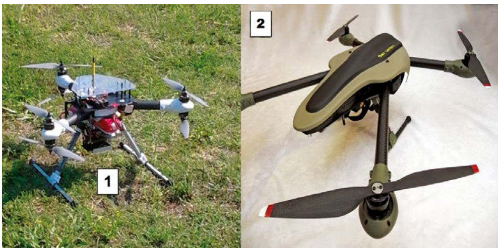
Fig. 2 - Droni (Apr): 1) il drone utilizzato nel corso delle prove. Si noti il posizionamento della camera multispettrale; 2) l'evoluzione 2015 dello stesso, che rispetto al precedente offre una maggiore versatilità, dovuta alla più elevata capacità di carico e autonomia di volo.
